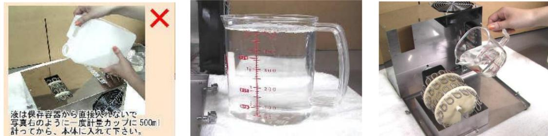
シャボン玉液を入れるときは保存容器から計量カップに移してから一杯だけ(500ml)を機械にセットして下さい。
