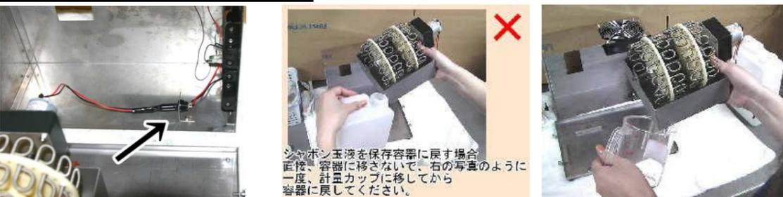
シャボン玉液を保存容器に戻す場合、直接、容器に移さないで、右の写真のように一度、計量カップに移してから容器に戻して下さい。
