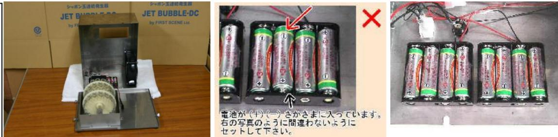
電池をセットする時は左写真のようにフタを立てるとセットが容易です。
