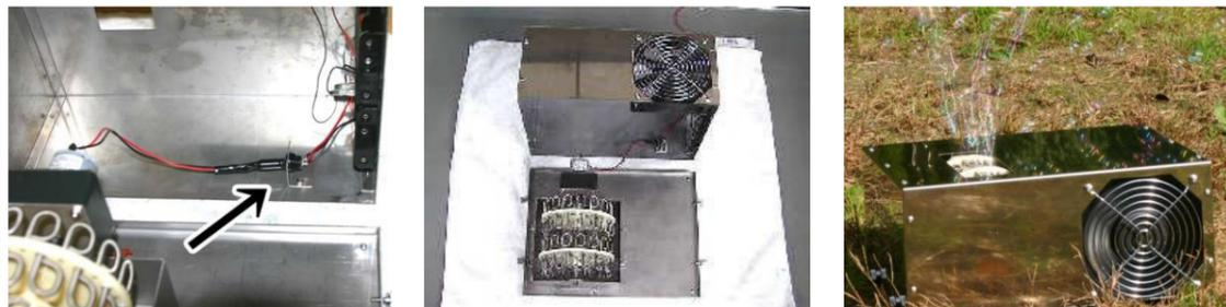
シャボン玉発生部のモーターに付いている凸型プラグを本体内部凹型プラグに差込みます。
