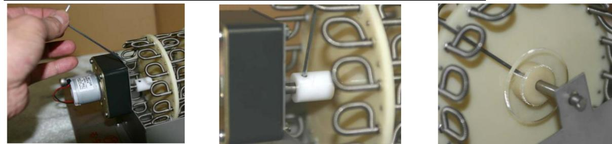
振動などにより、モーター及び羽根とシャフトの固定しているボルトがゆるみます。外れた場合付属の六角棒スパナでゆるめにお締め下さい。
